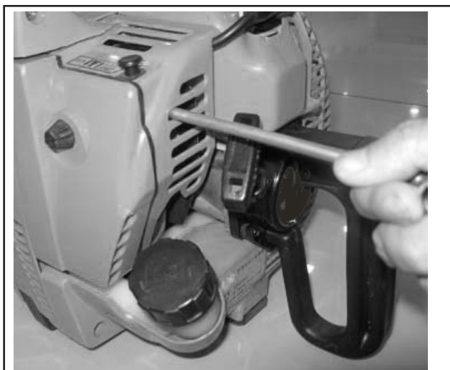
Регулировочный винт оборотов XX доступен через решетку крышки.
